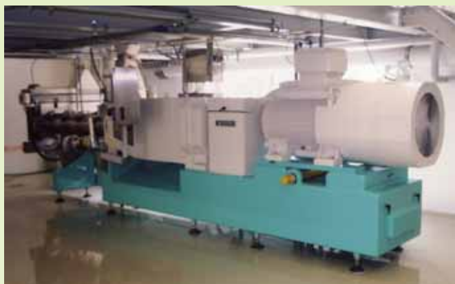
Der Extruder - dient zur Aufschließung der Stärke
